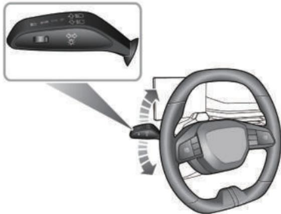
Den Beleuchtungshebel nach unten drücken, um eine Fahrtrichtung nach LINKS anzuzeigen. Den Beleuchtungshebel nach oben drücken, um eine Fahrtrichtung nach RECHTS anzuzeigen. Die entsprechende GRÜNE Fahrtrichtungsanzeige im Kombiinstrument blinkt, während der Blinker eingeschaltet ist. Durch Drehen des Lenkrads wird die Blinkerbetätigung abgebrochen (geringfügige Lenkradbewegungen reichen zum eigenständigen Abbrechen des Blinkens möglicherweise nicht aus). Um einen Spurwechsel
