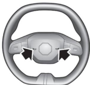
Drücken Sie zum Betätigen der Hupe den Hupenbereich (mit Pfeil gekennzeichnet) am Lenkrad.
