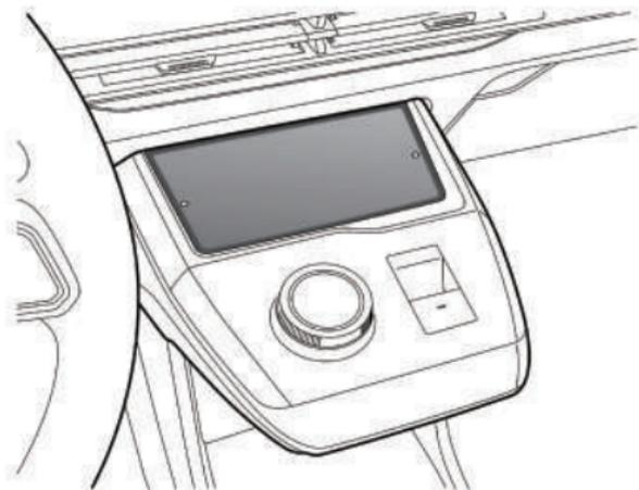
Der Bereich für das kabellose Laden von Mobiltelefonen befindet sich vor dem Schalthebel. Die Ladefunktion ist bei eingeschaltetem Fahrzeug aktiviert. Legen Sie das Telefon mit der Frontseite nach oben in den Ladebereich, der für das kabellose Laden genutzt werden kann.
