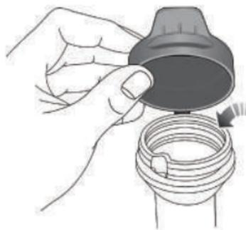
**Hinweis:** Verwenden Sie KEINE Frostschutzmittel oder Essig-/Wasserlösungen in der Waschflüssigkeit - Frostschutzmittel beschädigen den Lack und Essig schadet der Waschflüssigkeitspumpe.
