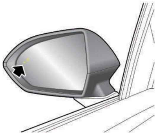
Wenn Kollisionsgefahr besteht, leuchtet die Warnanzeige der entsprechenden Seite. Wird die Tür dann trotzdem geöffnet, blinkt die Warnanzeige. Zugleich ist ein Warnton zu hören.
