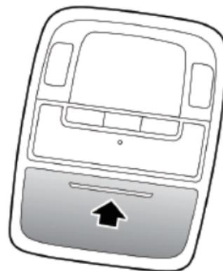
Das Brillenfach befindet sich in der Nähe der vorderen Innenraumleuchten. Drücken Sie auf den Deckel (siehe Pfeil) und legen Sie die Brille nach dem Öffnen des Fachs hinein. Schließen Sie das Brillenfach, wenn es nicht benutzt wird.
